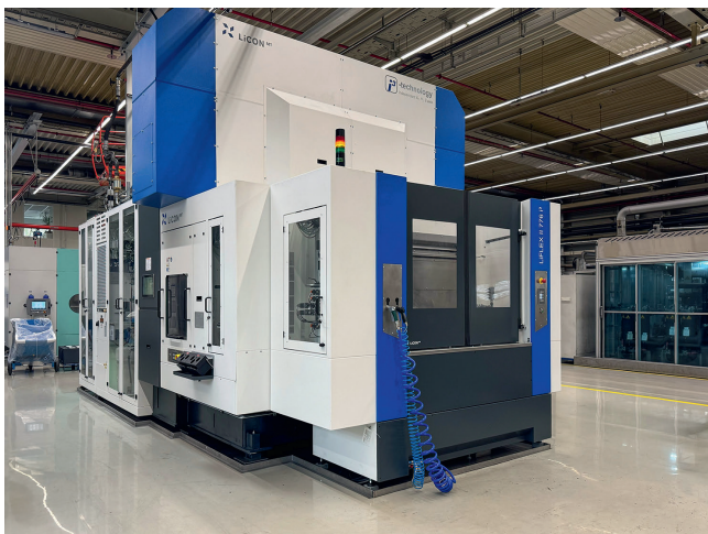
Anfang 2025 wurde der Doppelspindel LiFlex II 776 i³ mit Palettenwechsler bei Bosch Rexroth in Betrieb genommen © Licon
